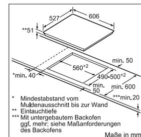
PXY695DX6E – ComfortProfil    PXY621DX6E – flächenbündig    PXE695DV5E – ComfortProfil    PXX695FC5E – ComfortProfil
