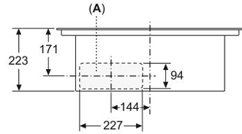
A: Direkt an der Rückseite angeschlossen
