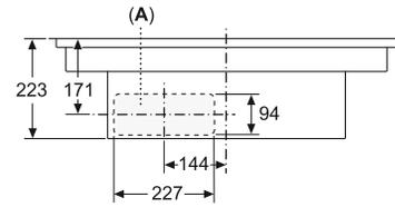
A: Direkt an der Rückseite angeschlossen
