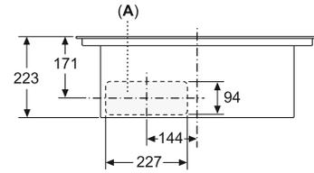
A: Direkt an der Rückseite angeschlossen
