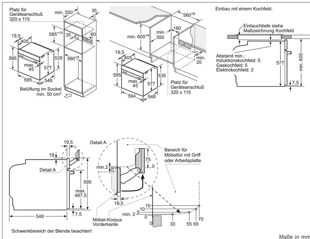
Wird das Gerät unter einem Kochfeld eingebaut, muss folgende Arbeitsplattenstärke (ggf. inkl. Unterkonstruktion) beachtet werden.
